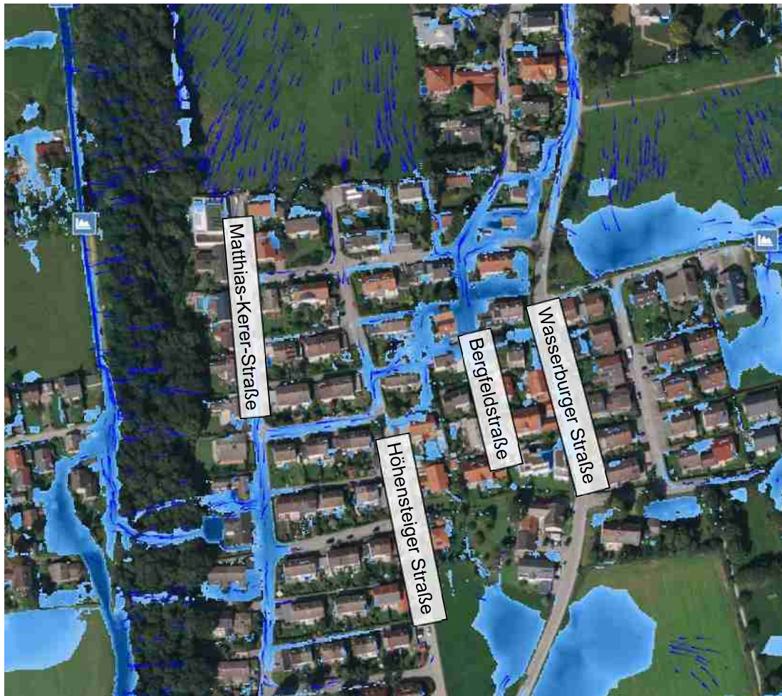
Abbildung 36: Fließweg von der Wasserburger Straße aus kommend
